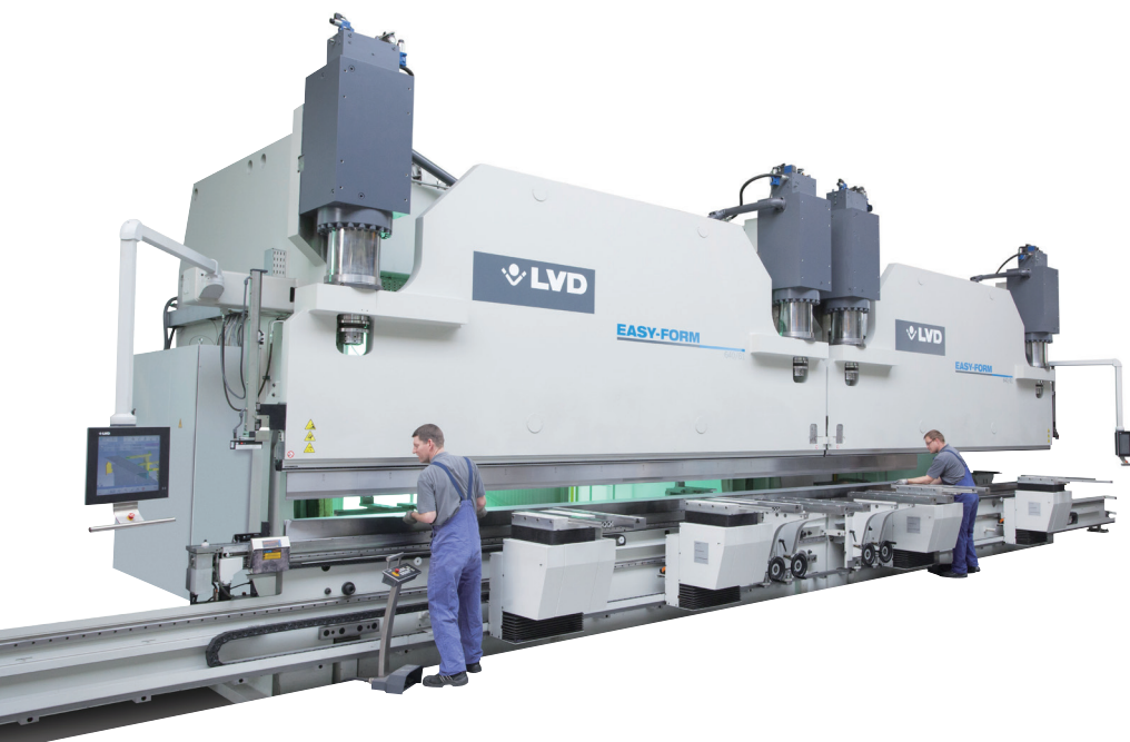
双机联动操作：可用一台主控制器同步操作两台设备或者分别独立用控制器控制对应设备，可在不同吨位和长度的设备上实现联动配置。
