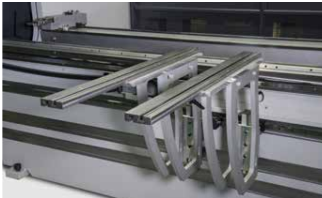
Podpory przednie mocowane na prowadnicach, umożliwiające szybkie pozycjonowanie wzdłuż całej długości roboczej maszyny.
