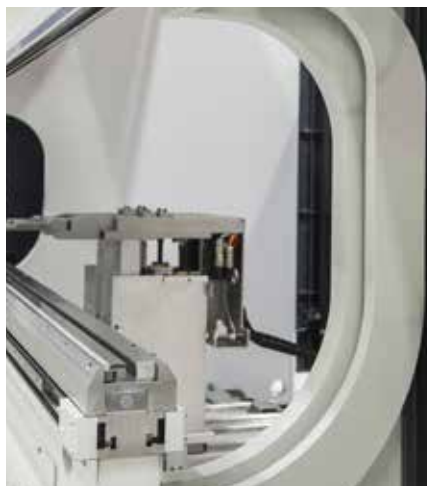
Erweiterter Abstand Tisch-Stößel/Hub/ Ausladung in 100 mm Schritten
